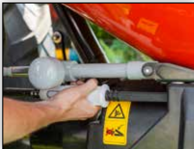
Einfache Einstellung der Streumenge
