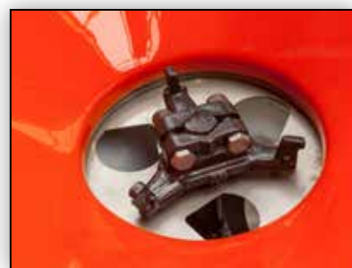
Rührfinger garantiert gleichmäßigen Düngerzufluß
