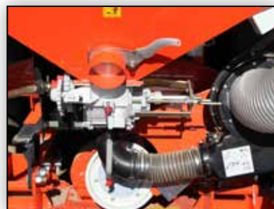
Alle Einstellungen am Dosiergerät erfolgen werkzeuglos.
