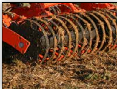
Exakte Einebnung und streifenweise Rückverfestigung mit der Actiflexwalze.
