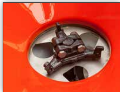
Rührfinger garantiert gleichmäßigen Düngerzufluß
