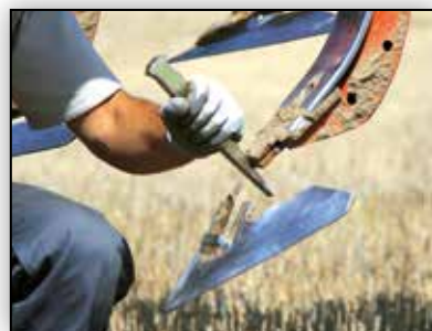
Schneller und einfacher Wechsel der Scharspitzen.
