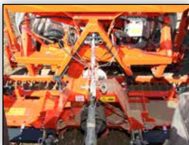
Satteldreieck als Schnittstelle zur Kreiselegge – für schnelles Entkoppeln.
