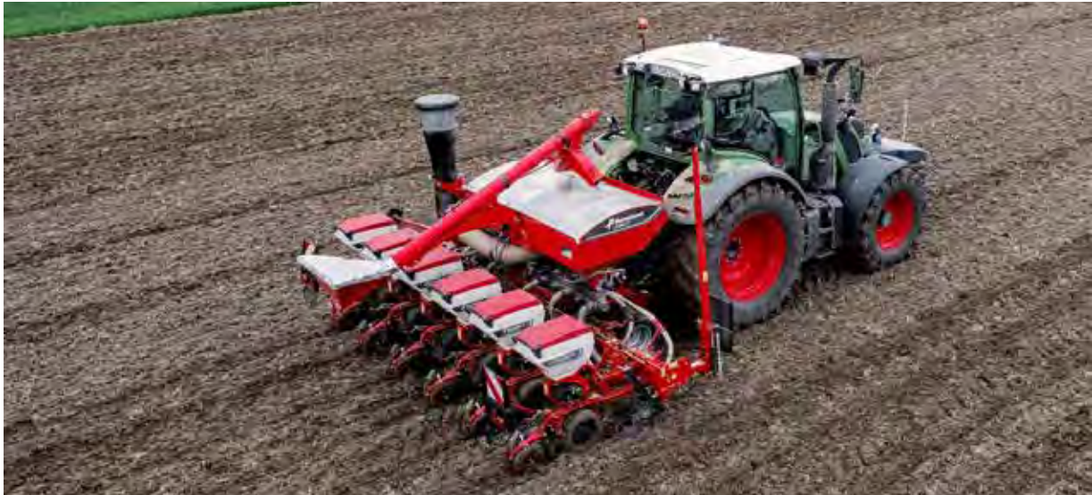
High Speed Aussaat mit der Optima V und SX Säreihe - hydraulisch verschiebbare Reihenweite
