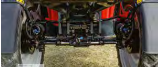
Bsp.: lange Spurstange an ungefederter Lenkachse T3
