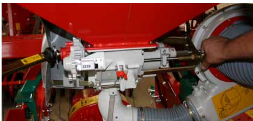
Alle Einstellungen am Dosiergerät erfolgen werkzeuglos
