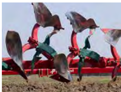
Blattfedersteinsicherung
