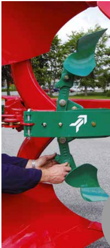
Vorschäler mit einfacher Tiefenverstellung
