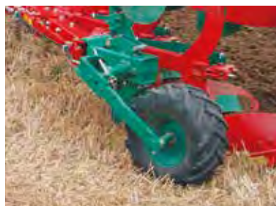
Hinten angebautes Stütz- und Transportrad mit hydraulischer Tiefenverstellung
