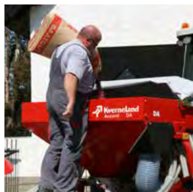
Sichere Befüllung dank Beladestufe
