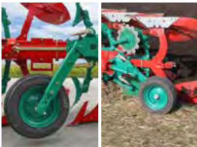
Hinten angebautes Stützrad mit Teleskop-arm
