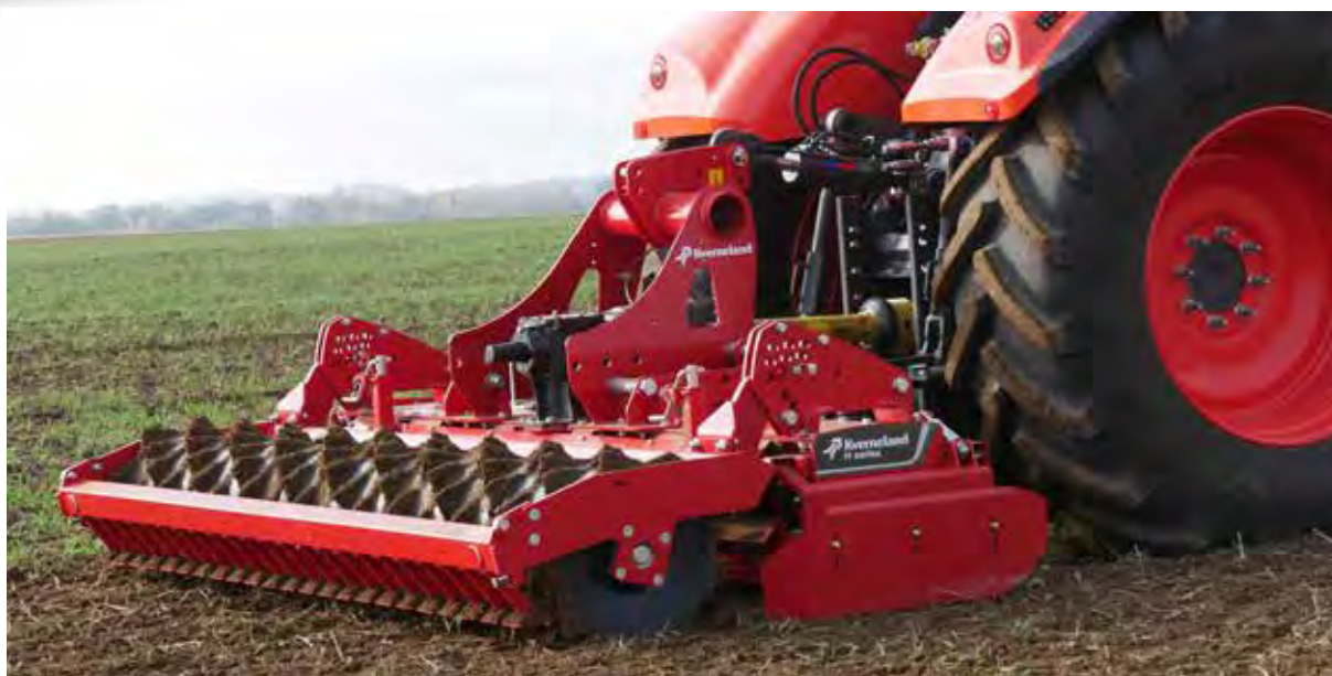
Kreiselege H-Serie 3,00 m mit Zahnpackerwalze Ø 575 mm
