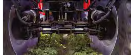
Bsp.: kurze Spurstange an gefederte Lenkachse T4
