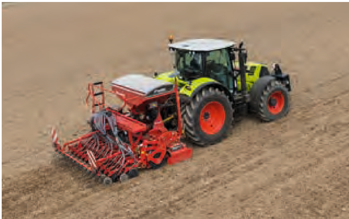
e-drill compact mit 1.100 l (1.400 l) Saattankvolumen
