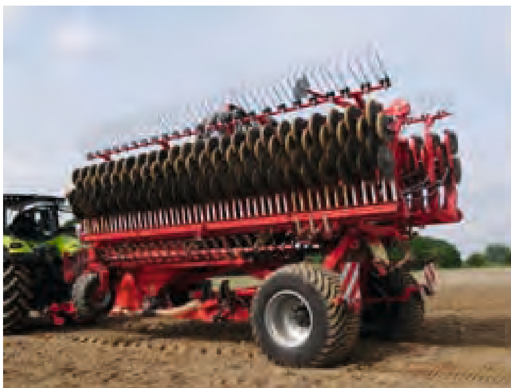
DG-II 12 m in Transportstellung – sicher und kompakt auf der Straße
