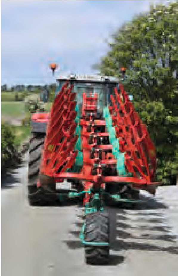
Transportstellung | Hinten angebautes Stütz- und Transportrad
