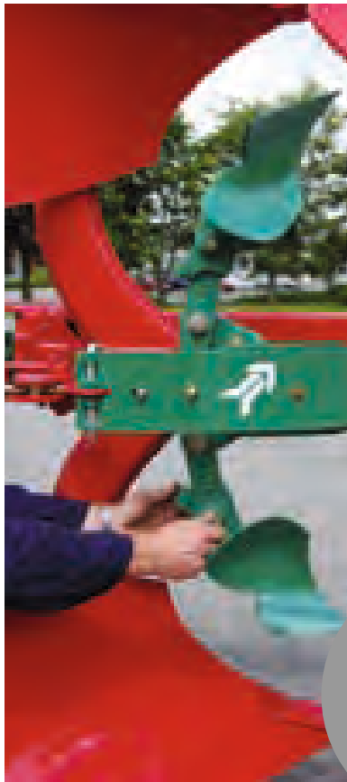
Vorschäler mit einfacher Tiefenverstellung
