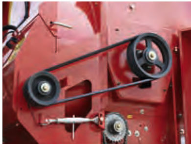
Keilriemenantrieb als Überlastschutz
