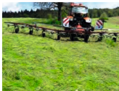
Hervorragende Bodenanpassung über die gesamte Arbeitsbreite. Jeder Rotor kann sich einzeln den Bodenkonturen anpassen.
