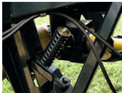
NonStop Anfahrtsicherung: Die Mäheinheit weicht nach oben und nach hinten aus und kommt automatisch in die Ausgangsposition zurück.
