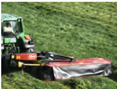
Bodendruckentlastung: Die Bodendruckentlastung wird hydraulisch eingestellt.
