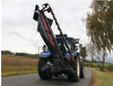
Transportposition: Das Mähwerk klappt in eine 125° Transportposition.
