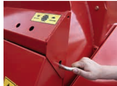
2-Stufen-Schaltgetriebe zum Füttern oder Einstreuen
