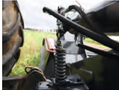
NonStop Anfahrtsicherung: Die Mäheinheit weicht nach oben und nach hinten aus und kommt automatisch in die Ausgangsposition zurück.
