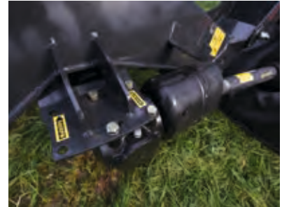
Zwei Zapfwellengeschwindigkeiten Serie: 540 oder 1.000 U/min durch drehen des Getriebes möglich.
