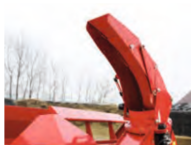
Der Schwanenhalsauswurf ist um 310° drehbar
