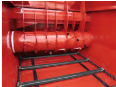
Die Kratzbodenleisten laufen schonend auf Kunststoffstreifen
