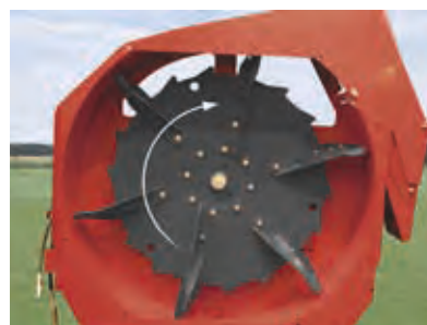
Schwungrad mit 1,55 m Durchmesser und 6 Wurfschaufeln
