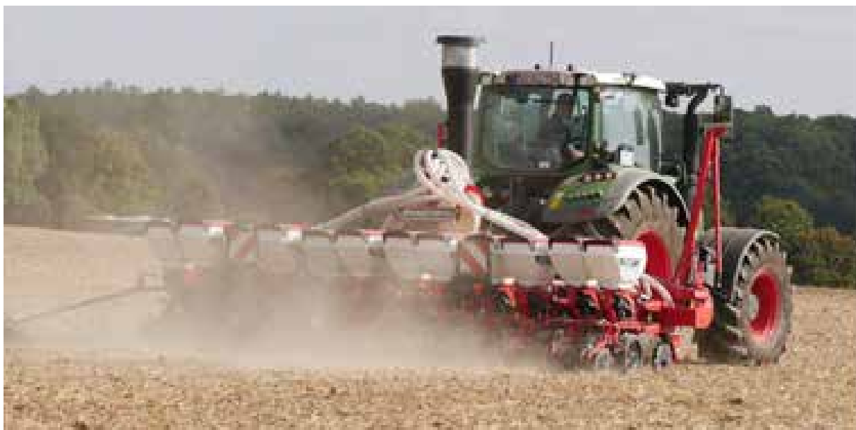
NEU Optima F 6 m hydraulisch klappbarer Rahmen 8 bis 12 reihig mit SX Highspeed Säreihe
