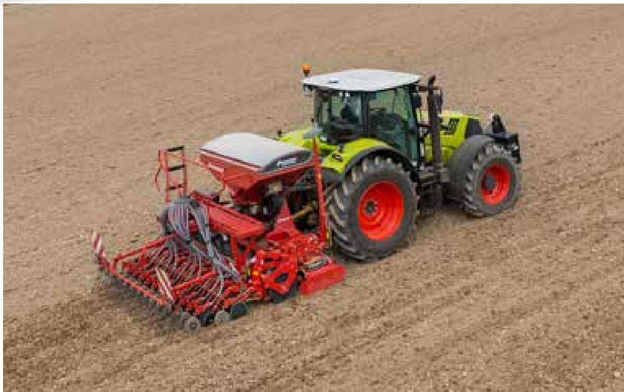
e-drill compact mit 1.100 l (1.400 l) Saattankvolumen
