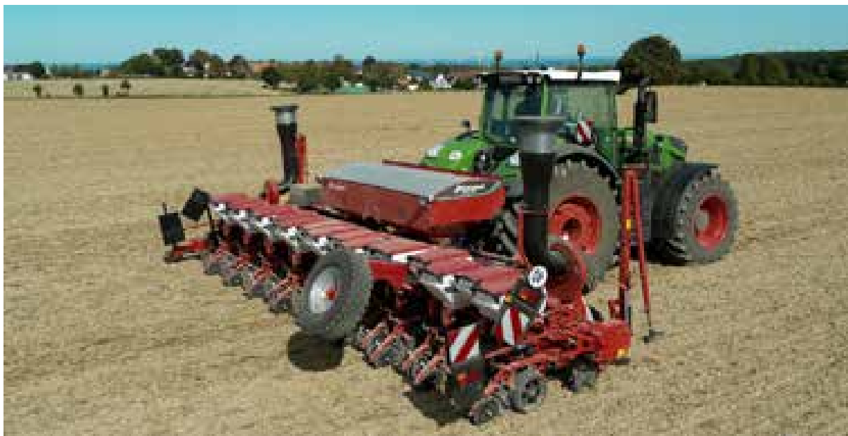
Optima RS Rahmen mit SX High Speed Säreihe 18 reihig (Reihenanzahl im Offset)
