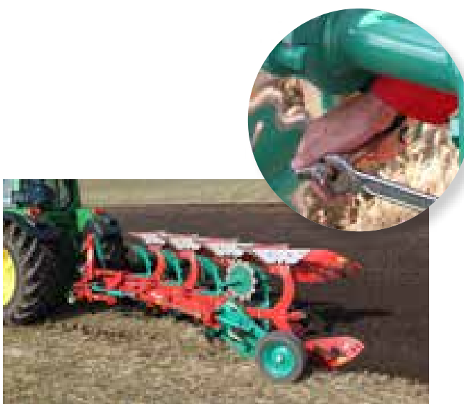
Einfache und schnelle Einstellung der Arbeitstiefe mit Y-Schrauben
