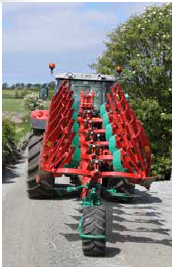
Transportstellung | Hinten angebautes Stütz- und Transportrad
