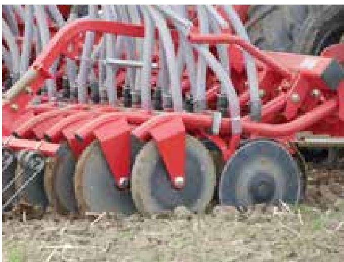
Applikation über zweiten Auslass am CD-Doppelscheibenschar "Double Entry"
