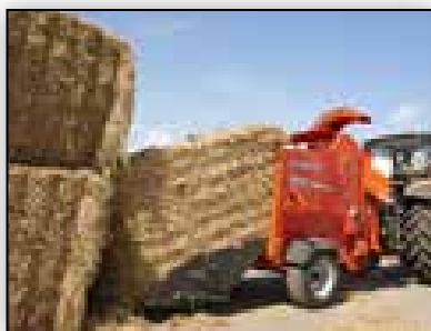
Bequemes und einfaches selbsttätiges Laden von Ballen.
