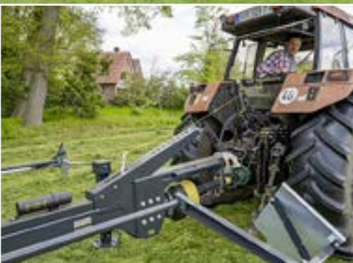
Der Wender kann oben oder unten im Zugmaul angehängt werden. Das Seil schaltet ein Ventil, um zwischen Grenzstreutuch und hydraulischer Tiefenstellung zu wechseln.
