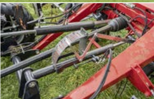
Ein Zylinder mit Sperrblock verändert die Rechttiefe der Zinken, eine gut ablesbare Skala gibt Orientierung für den Fahrer.
