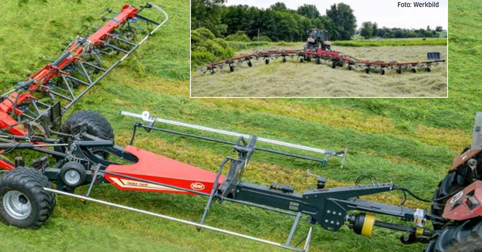
Die Boden Anpassung der 15 m breiten Maschine ist gut gelöst. 10 der 14 Kreisel sind zu je fünf Paaren fest miteinander verbunden. Foto: Werkbild
