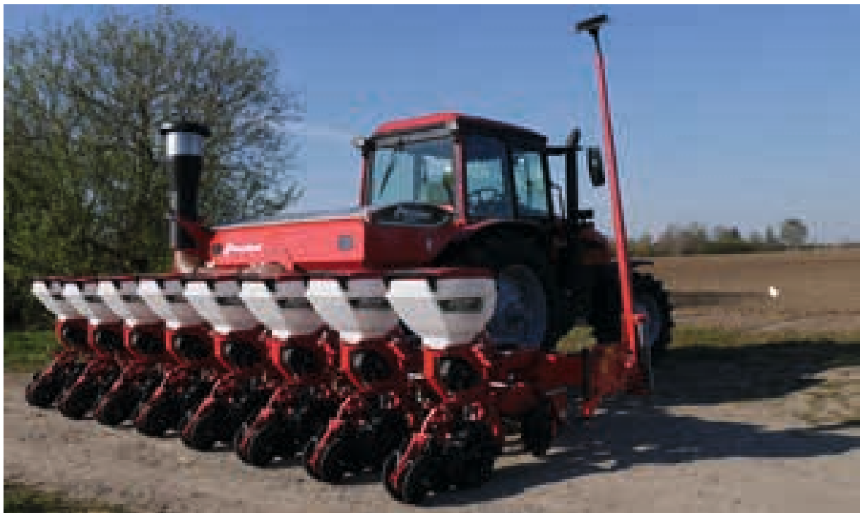
Optima R 6 m starr mit 8 SX Säreihen auf 75 cm Reihenweite
