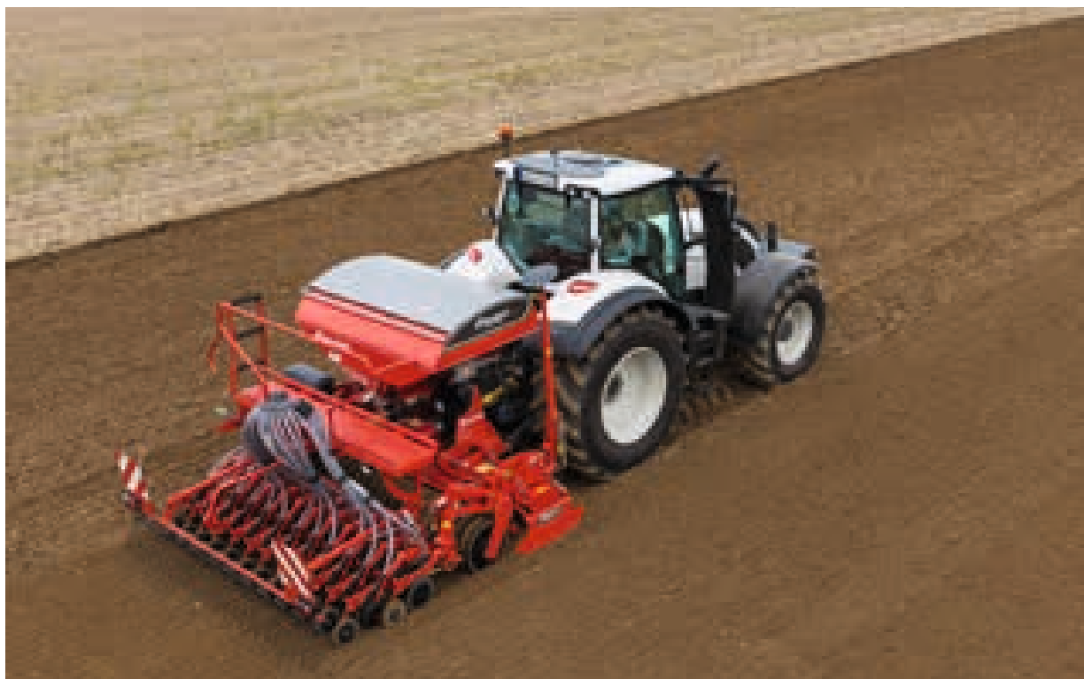
e-drill maxi mit 1.600 l (2.000 l) Saattankvolumen
