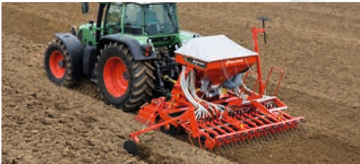
Leichte Aufsattel-Drillmaschine für Kreiselegen, Zinkenrotoren und Kurzkombinationen (Arbeitsbreiten: 2,50 und 3,00 m)
