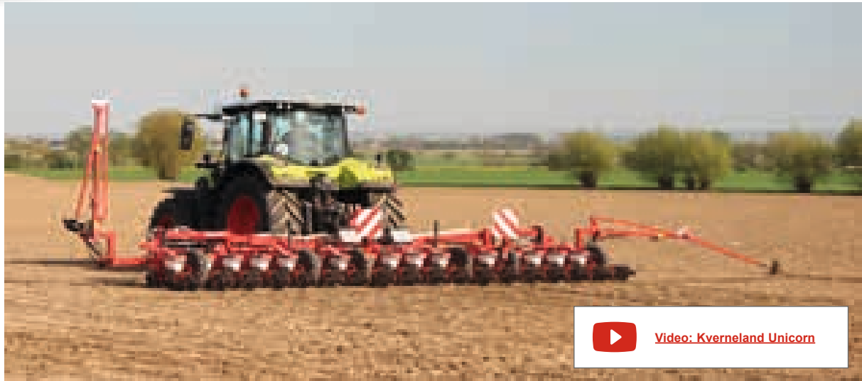
Kverneland Unicorn 9 m PH Rahmen mit 18 Mulchsaatreihen e-drive II
