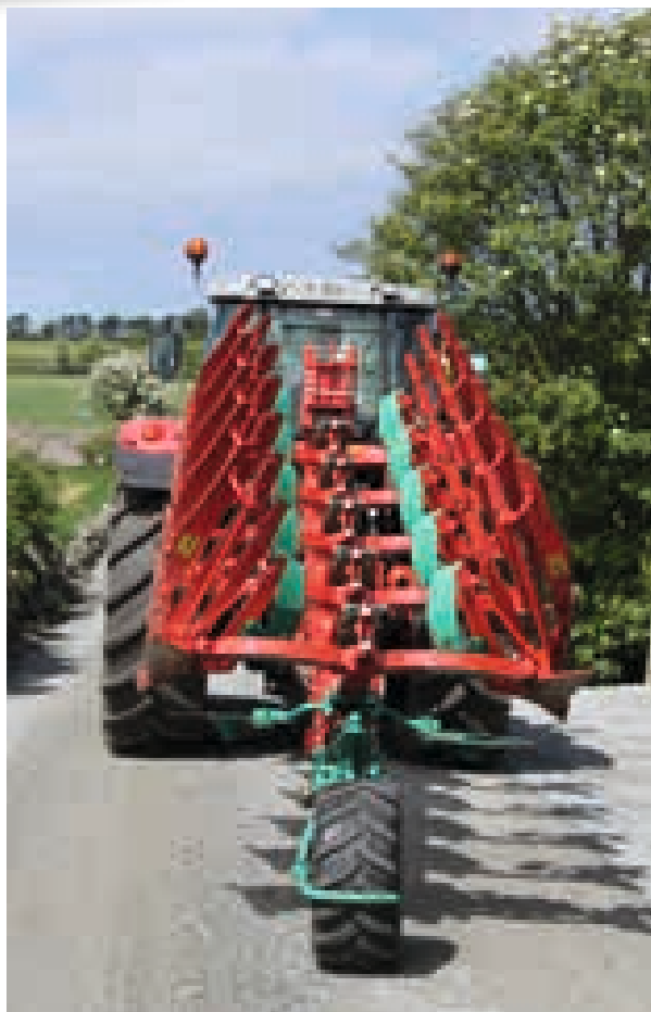
Transportstellung | Hinten angebautes Stütz- und Transportrad
