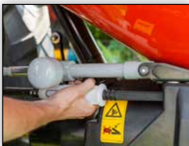
Einfache Einstellung der Streumenge
