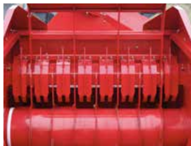
Drum Feed Control System bei 853 PRO (geschlossen)
