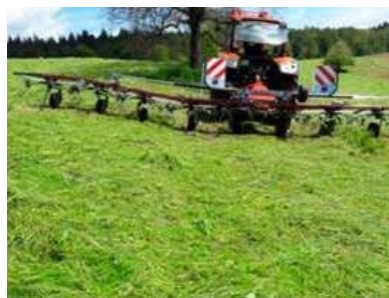
Hervorragende Bodenadaptation über die gesamte Arbeitsbreite. Jeder Rotor kann sich einzeln den Bodenkonturen anpassen.
