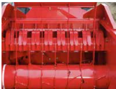
Drum Feed Control System bei 853 PRO (geöffnet)
