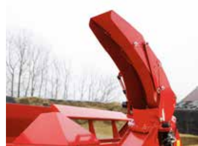
Der Schwanenhalsauswurf ist um 310° drehbar
