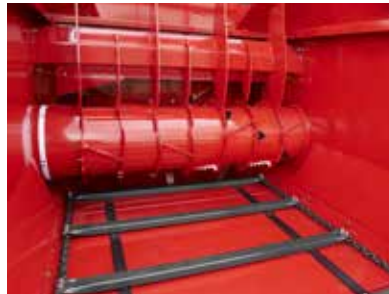
Die Kratzbodenleisten laufen schonend auf Kunststoffstreifen
