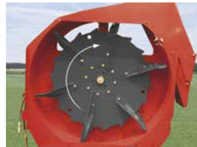
Schwungrad mit 1,55 m Durchmesser und 6 Wurfschaufeln
