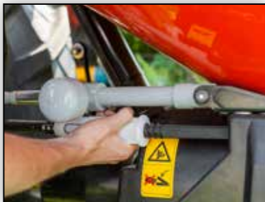
Einfache Einstellung der Streumenge
