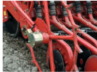
Sporenrad mit integrierter Bremse
