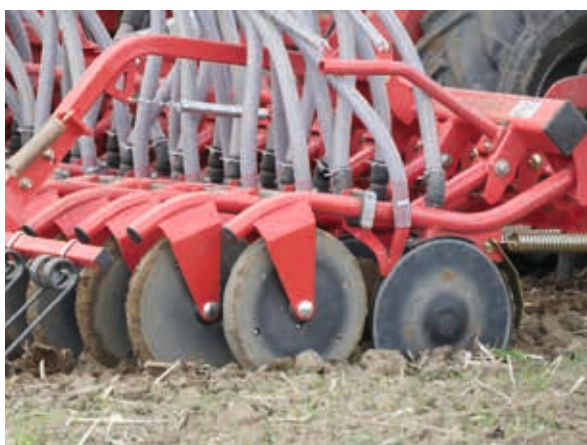
Applikation über zweiten Auslass am CD-Doppelscheibenschar "Double Entry"
