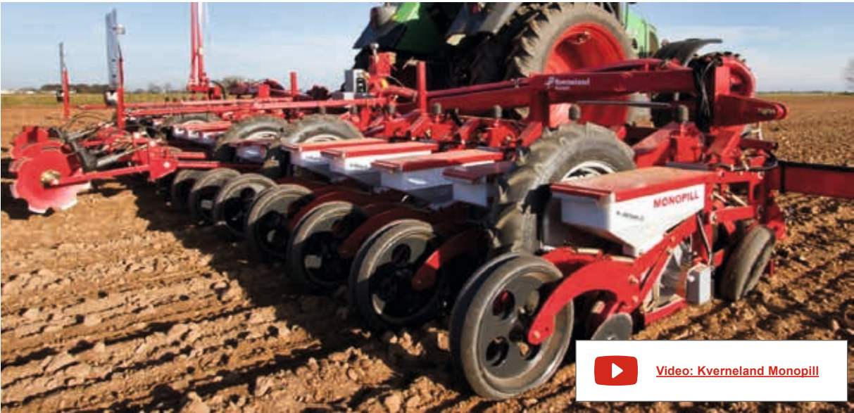
Mechanische Einzelkornsämaschine wahlweise mit elektrischem oder mechanischem Antrieb für höchste Präzision. Für pilliertes Rübensaatgut, Raps und Chicoreé.
