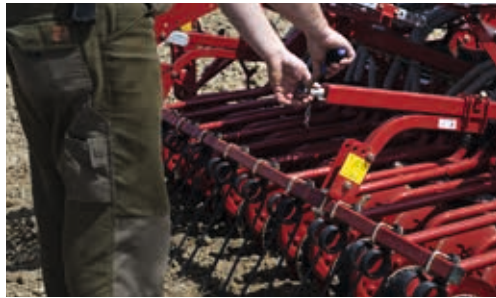
Abhängig von den Bodenverhältnissen können der Druck und Winkel der Striegel manuell eingestellt werden.
