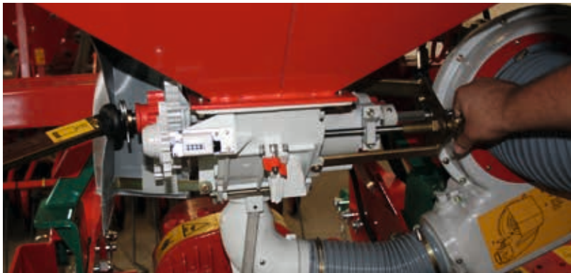
Alle Einstellungen am Dosiergerät erfolgen werkzeuglos
