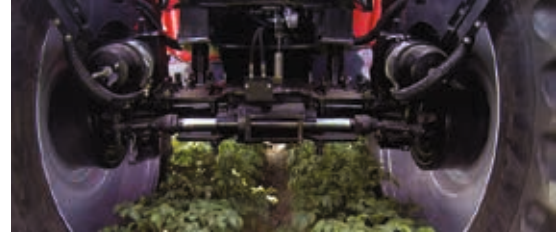
Bsp.: kurze Spurstange an gefederter Lenkachse T4
