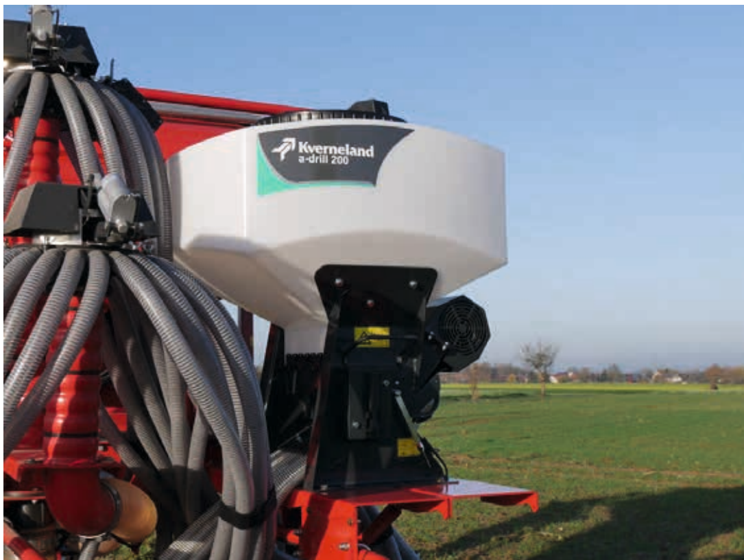
a-drill 200 in Kombination mit e-drill; Applikation vor dem Striegel über Prallbleche
