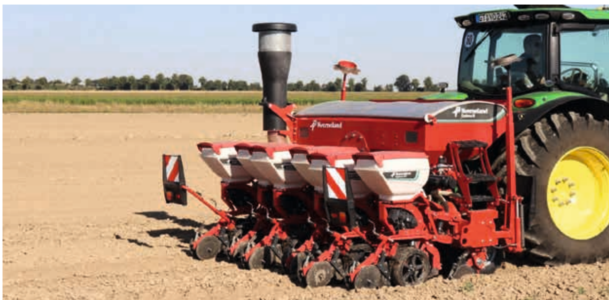
Optima R Rahmen 3 m mit 6 SX High Speed Säreihen auf 50 cm Reihenweite
