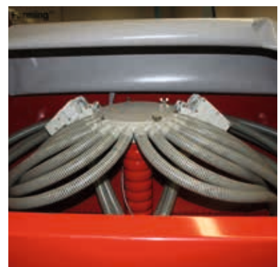
Im Tank liegender Verteilerkopf
