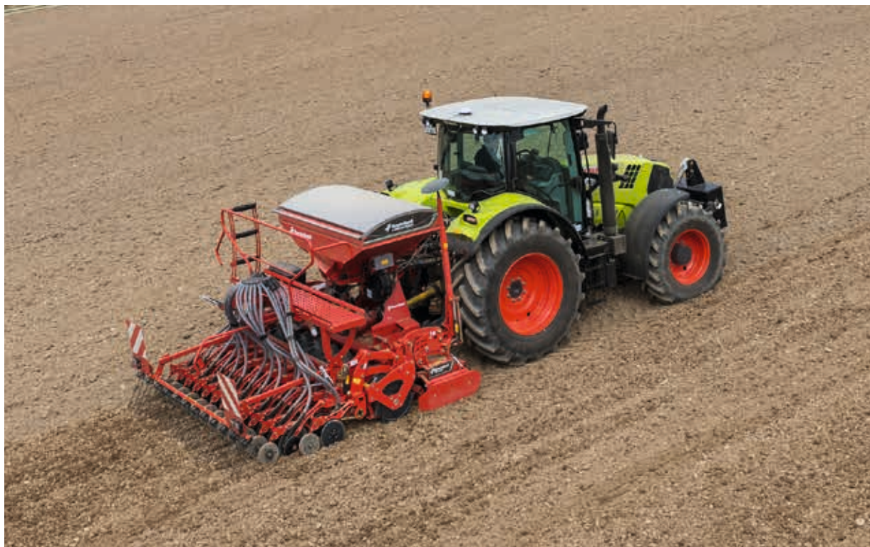
e-drill compact mit 1.100 l (1.400 l) Saattankvolumen
