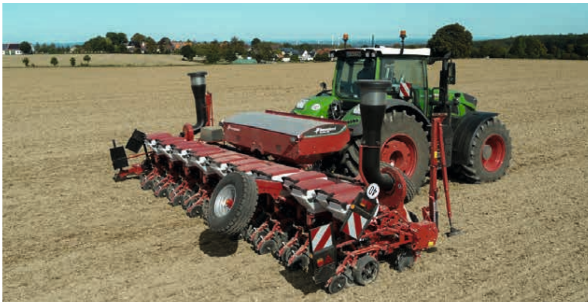
Optima RS Rahmen mit SX High Speed Säreihe 18 reihig (Reihenordnung im Offset)
