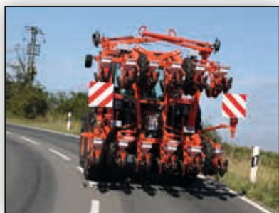
Sicherer Straßentransport durch kompakte Transportstellung.
