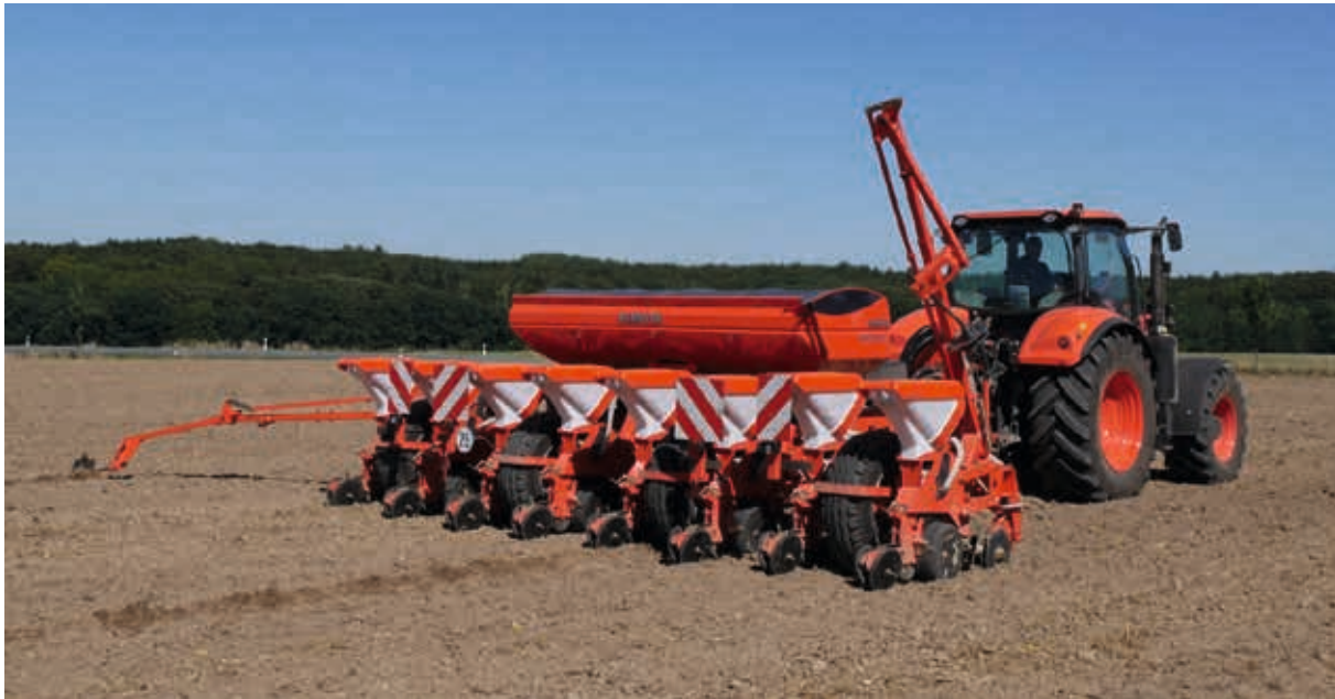
gezogene Einzelkornsämaschine PP1600TF 8-reihig mit HD-II Säreihe und 75 cm Reihenweite
