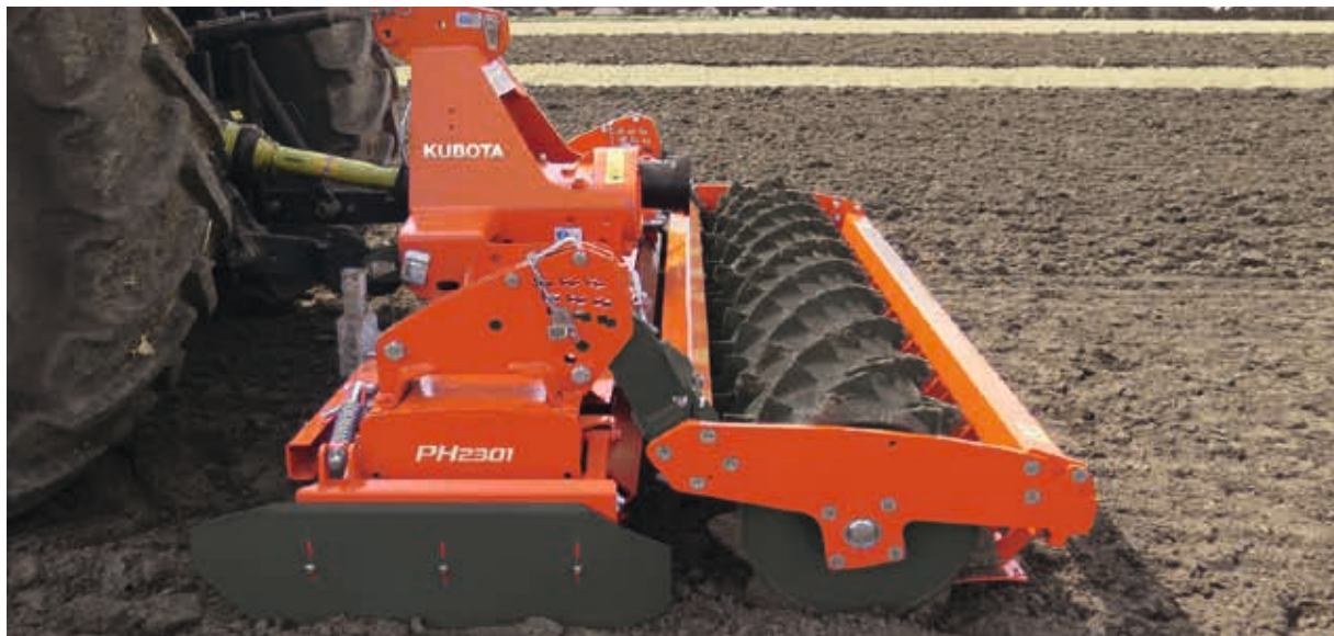
Kreiselegge PH2301 3,00 m mit Zahnpackerwalze Ø 575 mm
