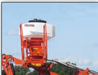
Eine pneumatische Sämaschine kann am Grubber integriert werden.
