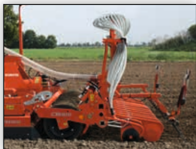
CB1300 Scharschiene. Perfekte Gewichtsverteilung durch aufgelöste Bauweise.
