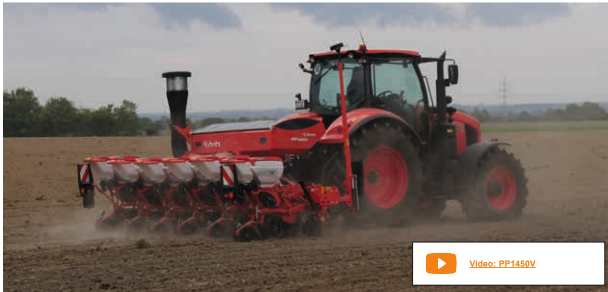
High Speed Aussaat mit der PP1450V und SX Säreihe - hydraulisch verschiebbare Reihenweite
